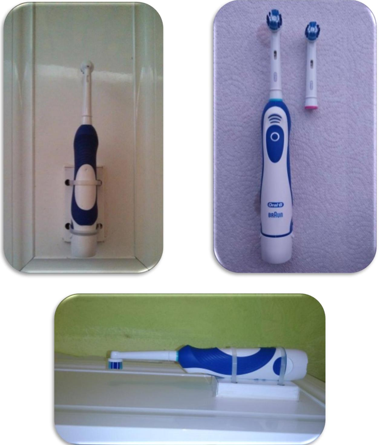
**Figura 15.** Dispositivo original que fue diseñado para este estudio con la finalidad de poder controlar la presión y el tiempo durante el cepillado de las muestras.
