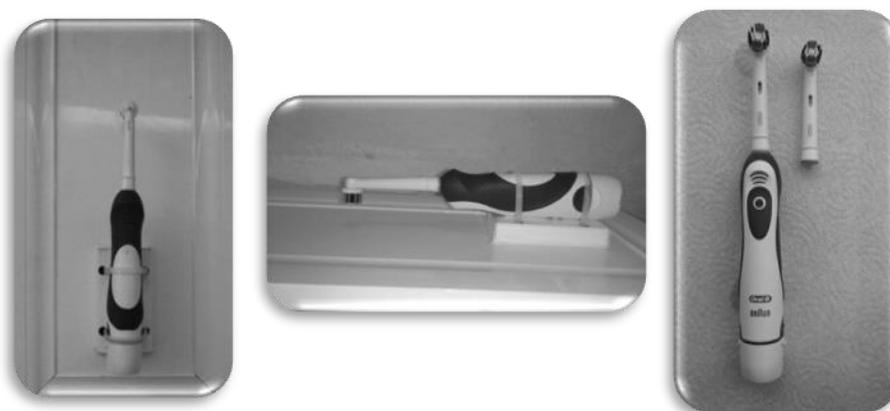
**Figura 1.** Dispositivo original que fue diseñado para el cepillado de las muestra y de esta manera poder controlar la presión ejercida durante el cepillado así como el tiempo.
